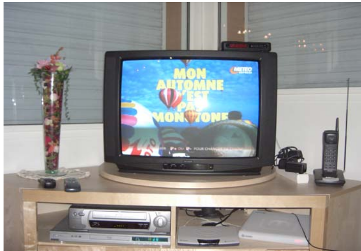
Figure 1 : Cette banale configuration « pèse » 110 W en Marche et 41 W en Veille. En mode Internet, les 110 W entraînent un appel quasi-équivalent de puissance supplémentaire au niveau des infrastructures
